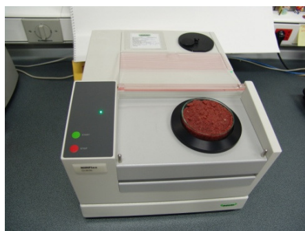
Fig. 1 - Spettrofotometro Buchi NIRFlex N-500
