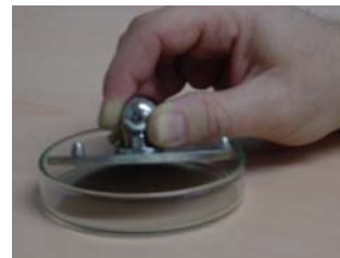
Fig. 2 – Accessorio per analisi in trasflettanza
