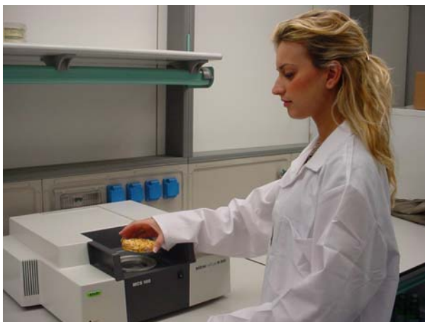
Fig. 1 - Spettrofotometro Buchi NIRLAB N-200
