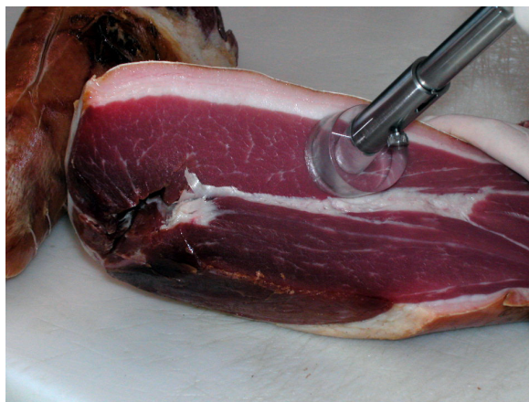
Figura 2: lettura tramite fibra ottica del muscolo Biceps femoris
