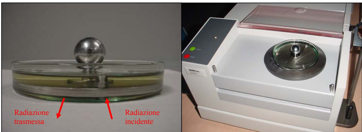
Fig. 2 - Analisi di una campione di olio adulterato in modalità di trasflettanza
