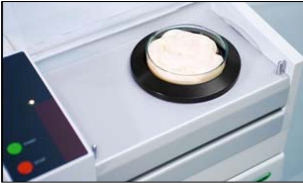
Fig. 1 – Analisi di un campione di burro in modalità di riflettanza diffusa
